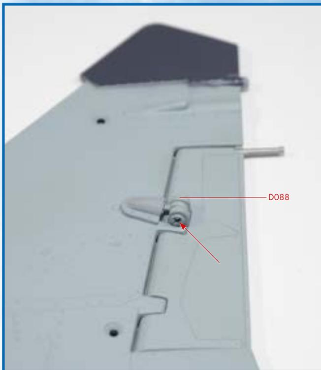
**5** Затем зафиксируйте вилку (D088) и тягу (P225) винтом НМ, как показано на снимке.
