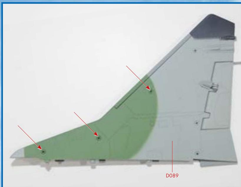
**8** Затем зафиксируйте две половинки кия тремя винтами LP с головками зеленого цвета.
