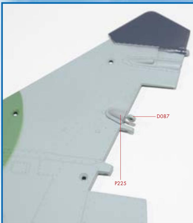
**3** Осторожно вставьте тягу привода руля направления (D087) в обтекатель (P225), как показано на снимке.
